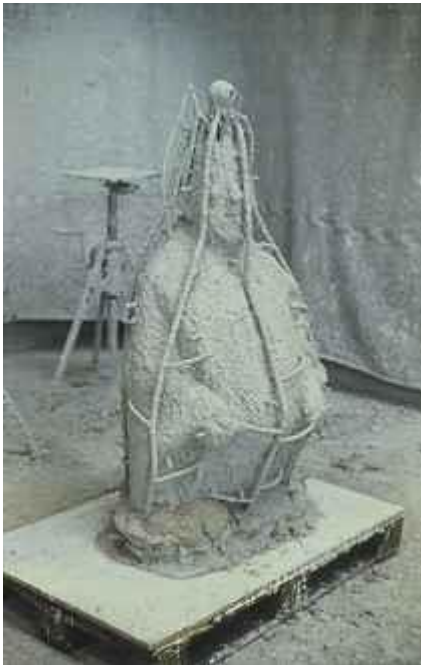
Entstehung der Schamotteform (Gießform). Erste Schamottschicht ist aufgetragen.
