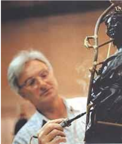
Mit dem Wissen, wie die flüssige Bronze später fließen soll, werden die Gußkanäle angebracht.
